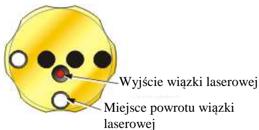
Rys. 10. Ustawienie głowicy laserowej w czasie kalibracji
